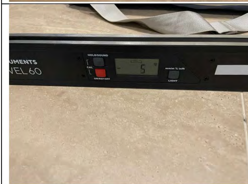
Фото №18. Измерения уровня напольного покрытия в санузле (плитка).
