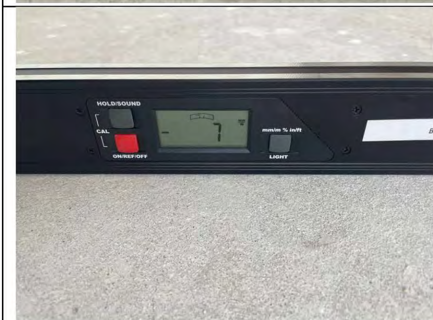
Фото №14. Измерения уровня напольного покрытия в спальне (ЦПС стяжка).
