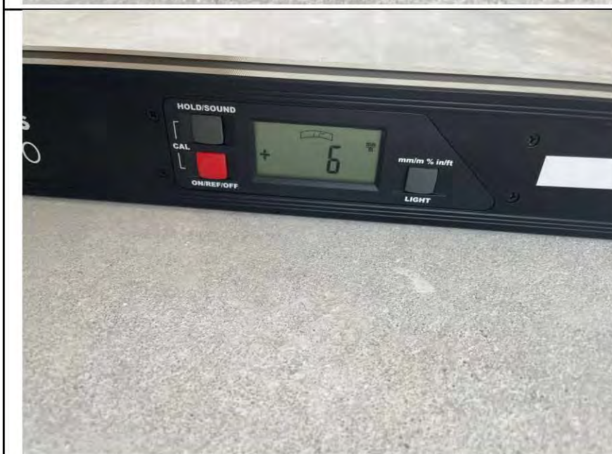
Фото №15. Измерения уровня напольного покрытия в гостиной (ЦПС стяжка).
