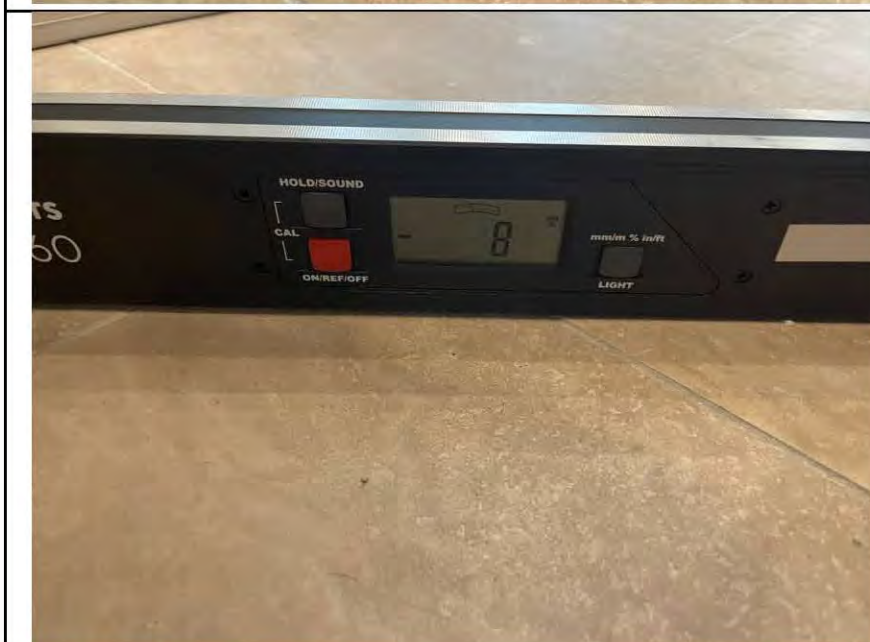
Фото №17. Измерения уровня напольного покрытия в ванной комнате (плитка).
