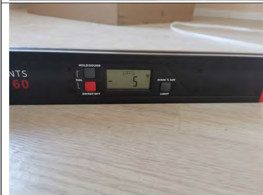
Фото №21. Отклонение напольного покрытия из ламината по горизонтали в кухне.
