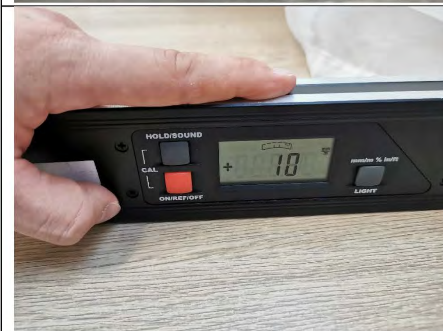
Фото №21. Измерение уровня пола в кухне-гостиной.
