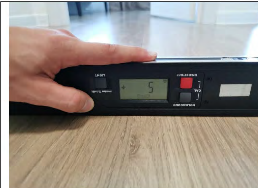
Фото №19. Измерение уровня пола в коридоре.
