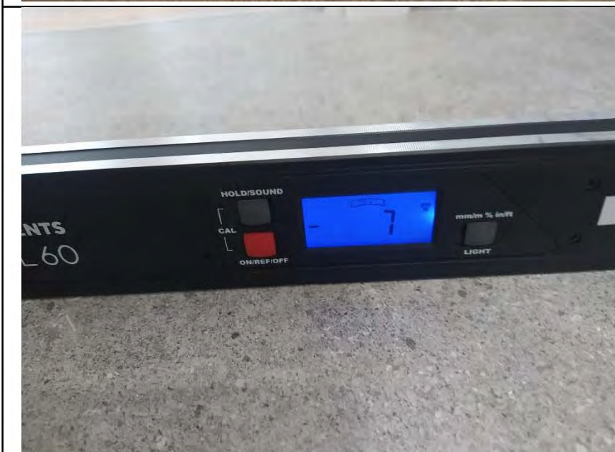
Фото №12. Измерение уровня напольного покрытия в ванной комнате (керамическая плитка).
