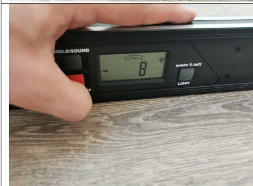
Фото №23. Измерение уровня пола в спальне.
