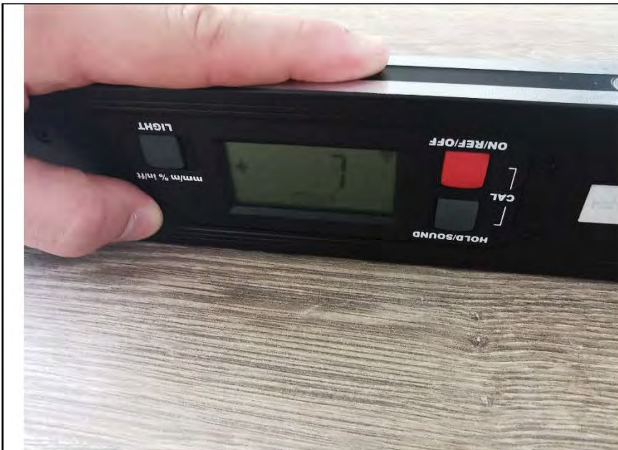
Фото №22. Измерение уровня пола в коридоре.
