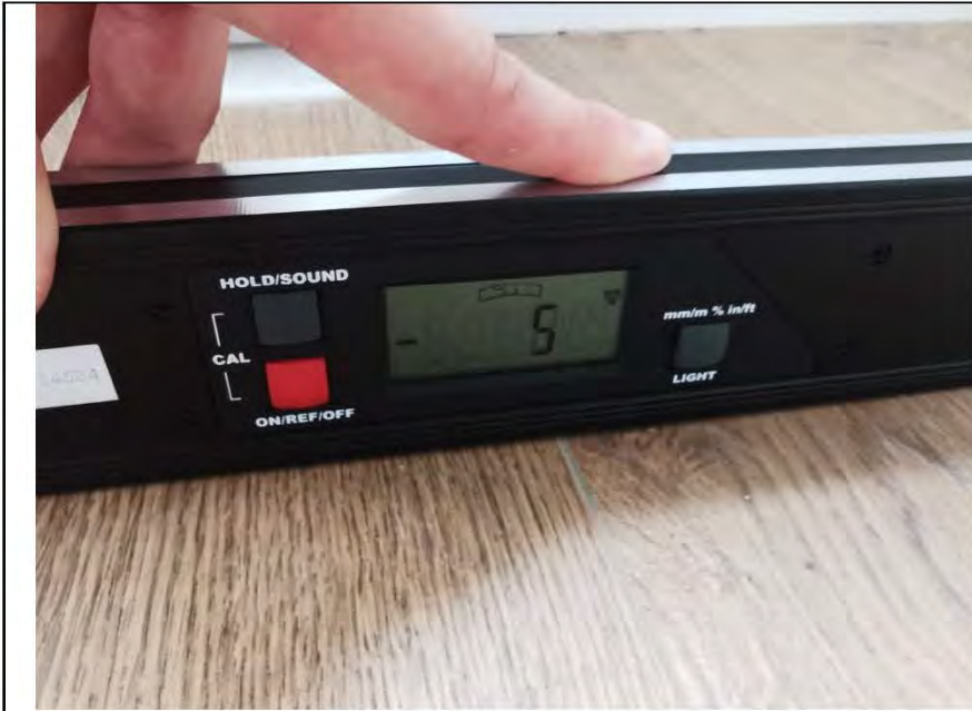
Фото №16. Измерение уровня пола в комнате.
