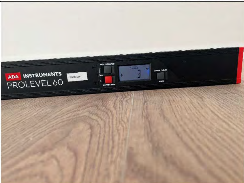
Фото №20. Измерение уровня напольного покрытия в спальне.
