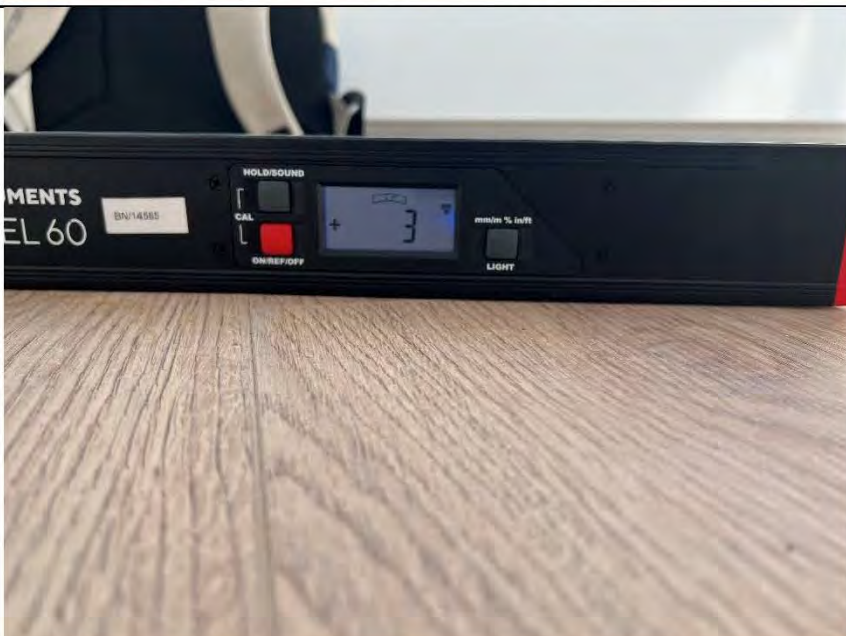
Фото №21. Измерение уровня напольного покрытия в кухне.
