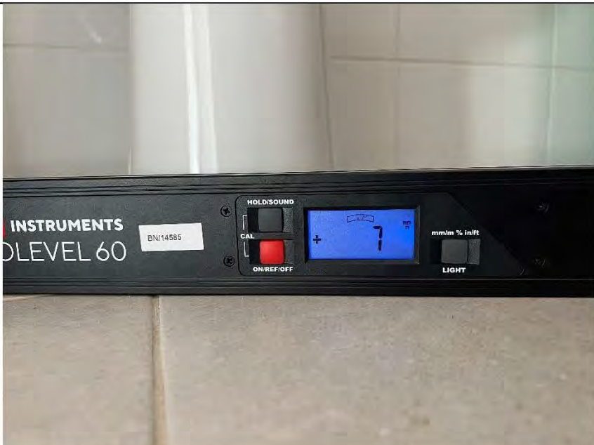
Фото №24. Измерение уровня напольного покрытия в ванной комнате.
