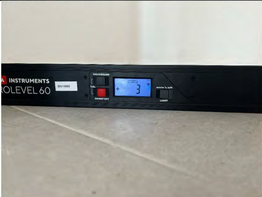
Фото №23. Измерение уровня напольного покрытия в прихожей.
