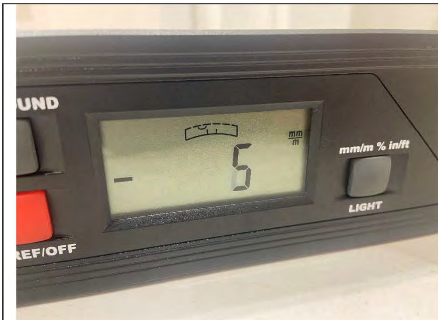
Фото №16. Отклонение поверхности напольного покрытия из керамической плитки в ванной комнате.
