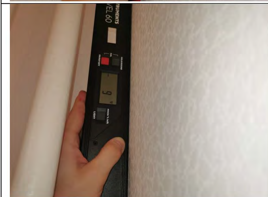
Фото №9. Измерение уровня стен в кухне.
