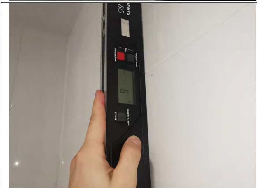
Фото №18. Измерение уровня стен в ванной комнате.
