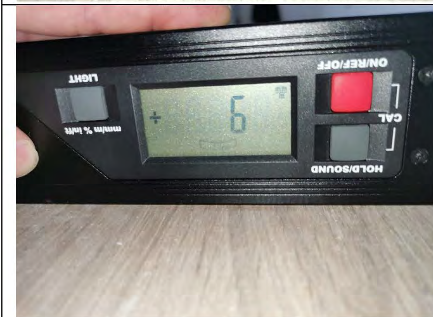
Фото №17. Измерение уровня пола в комнате.
