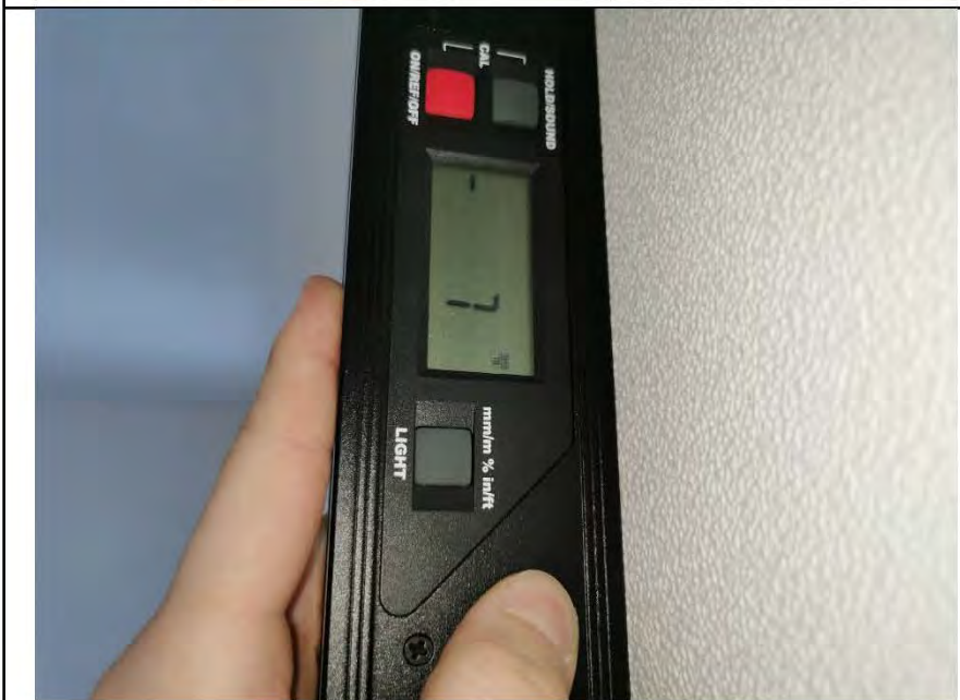
Фото №8. Измерение уровня стен в комнате.
