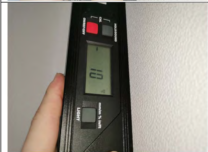
Фото №9. Измерение уровня стен в комнате.
