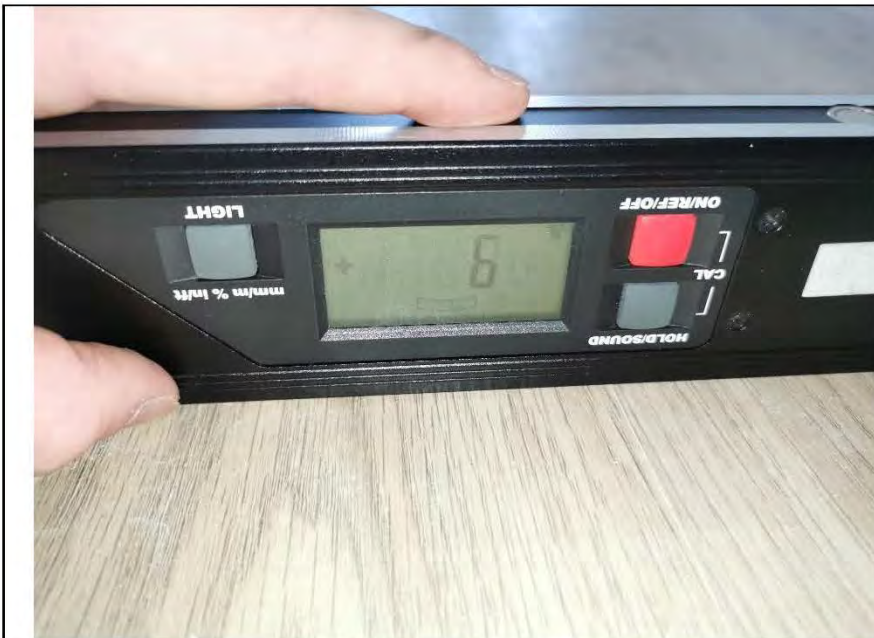
Фото №16. Измерение уровня пола в коридоре.
