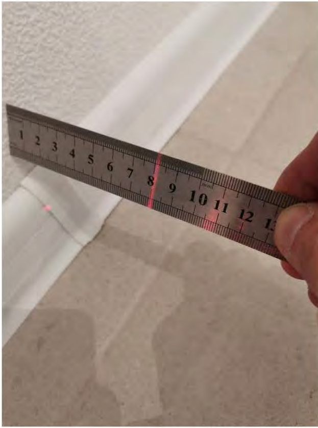
Фото 31, 32. Кухня-Комната 3.2 Отклонения участка стены от вертикали 8 мм
