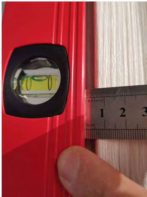
Фото 46. Гардеробная 4.1 Дверной блок имеет отклонение от вертикали 5 мм
