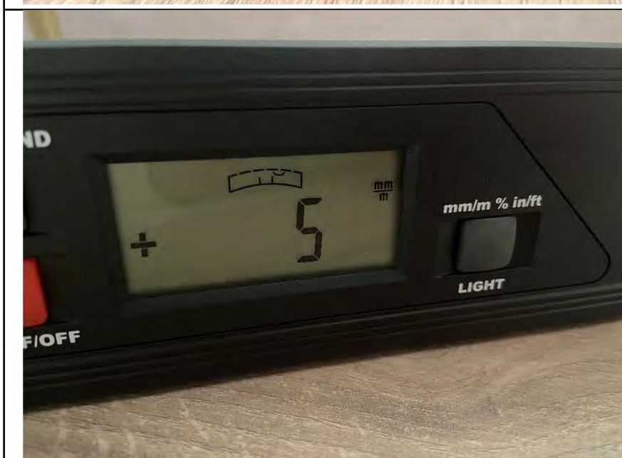
Фото №21. Отклонение поверхности напольного покрытия из ламината в спальне.
