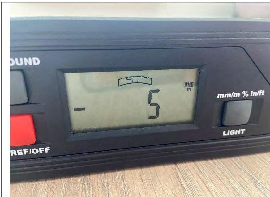
Фото №22. Отклонение поверхности напольного покрытия из ламината в кабинете.
