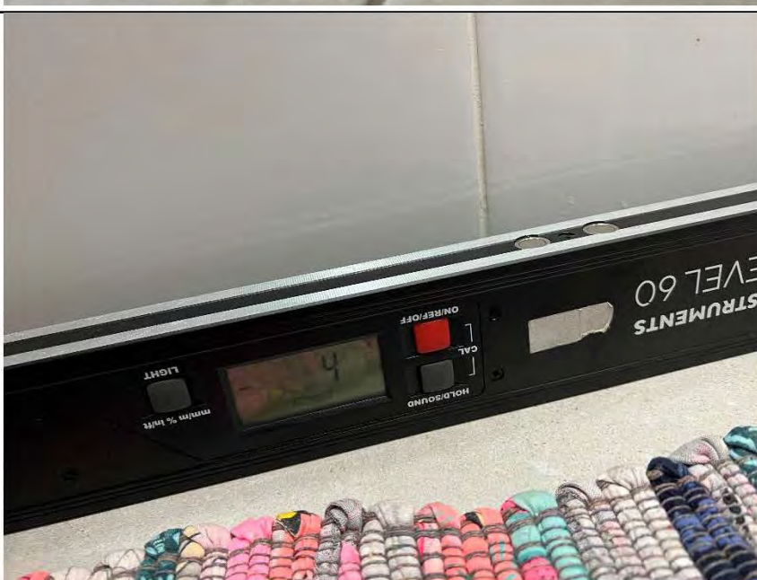
Фото №30. Измерение уровня напольного покрытия в санузле.
