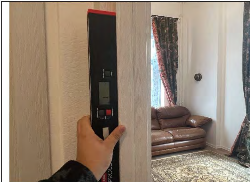
Фото №82. Отклонение коробки от плоскостности и прямолинейности дверного блока в гостиной составляет 7 мм.
