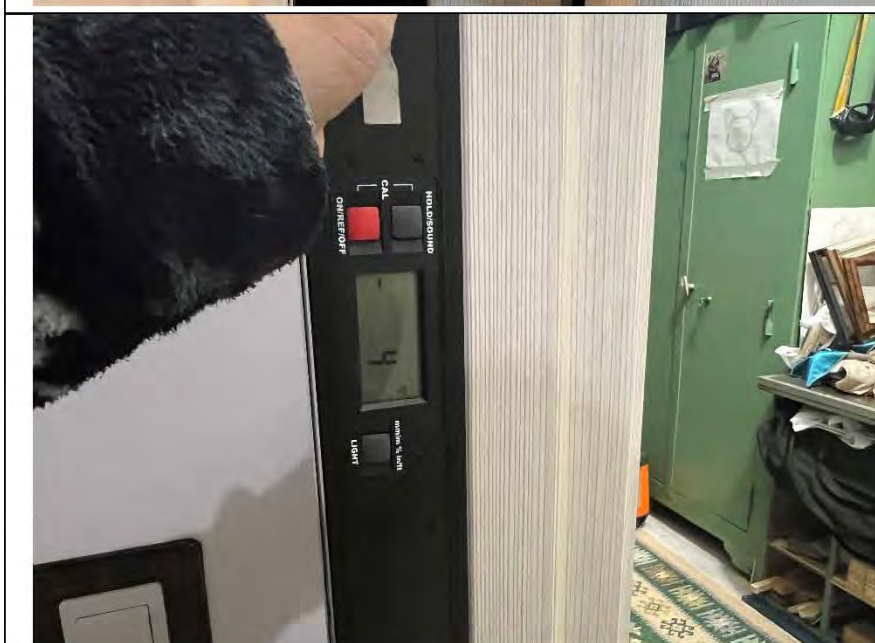
Фото №84. Отклонение коробки от плоскостности и прямолинейности дверного блока в гардеробной составляет 4 мм.
