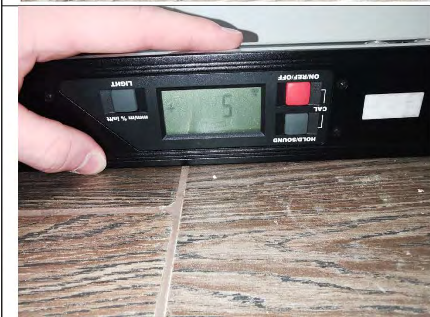
Фото №36. Измерение уровня пола в ванной комнате.
