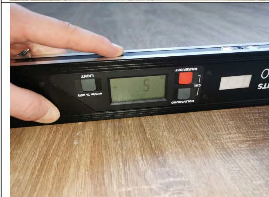
Фото №26. Измерение уровня пола в спальне.
