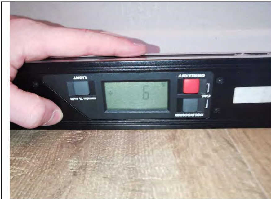
Фото №25. Измерение уровня пола в коридоре.
