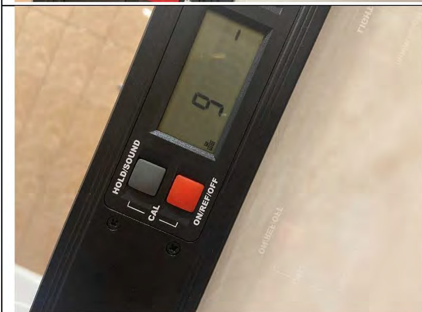
Фото №12. Измерение уровня стен в ванной комнате.
