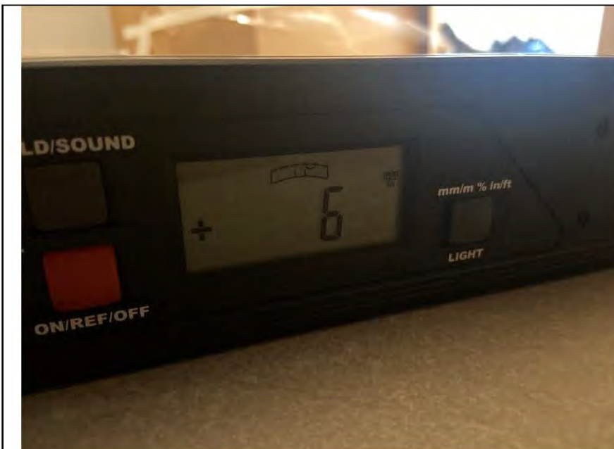
Фото №19. Отклонения напольного покрытия из керамической плитки в кладовке.
