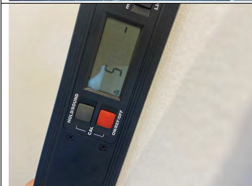
Фото №8. Измерение уровня стен в коридоре.
