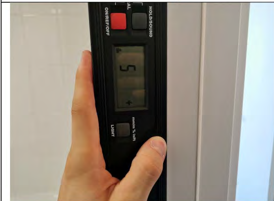
Фото №41. Отклонение коробки дверного блока от уровня вертикальности в ванной комнате.
