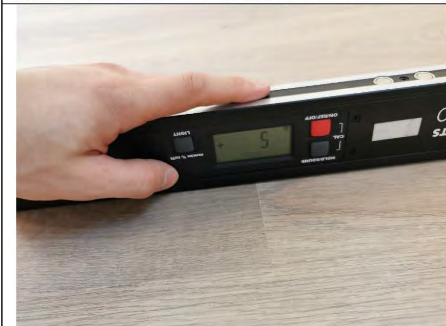
Фото №18. Измерение уровня пола в кухне-гостиной.
