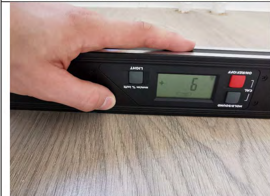
Фото №17. Измерение уровня пола в спальне.
