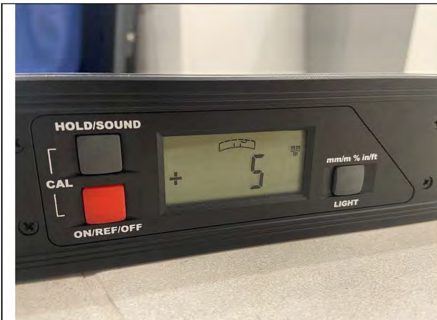
Фото №25. Отклонение напольного покрытия из керамической плитки в кухне.
