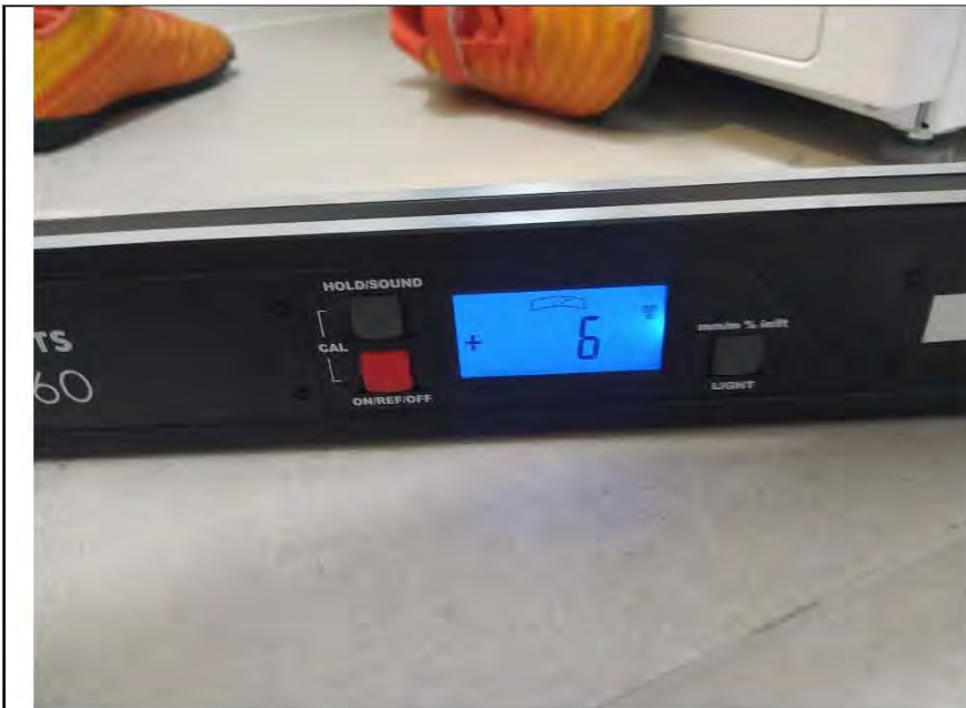
Фото №25. Измерение уровня напольного покрытия в прачечной (керамическая плитка).
