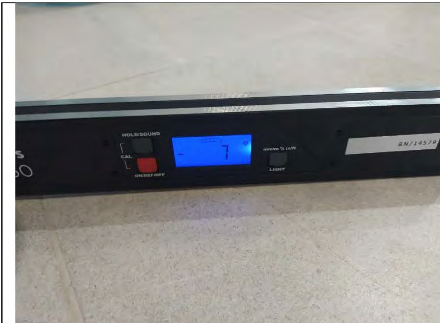
Фото №22. Измерение уровня напольного покрытия в прихожей (керамическая плитка).
