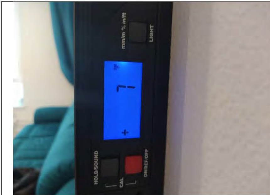
Фото №13. Измерение уровня стен в кухне.
