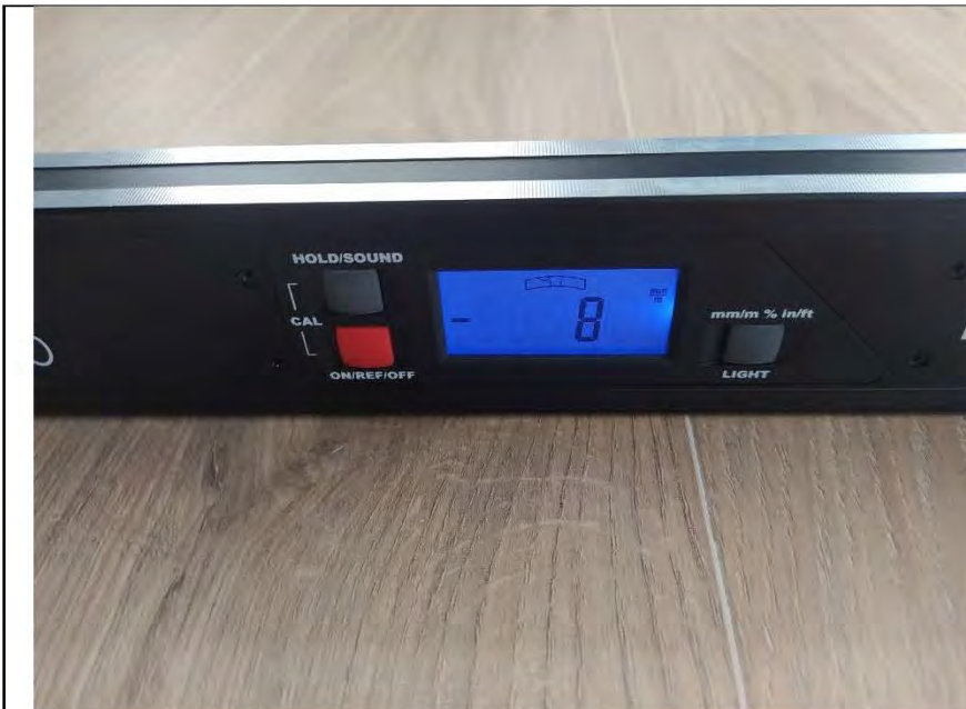
Фото №19. Измерение уровня напольного покрытия в гостиной.
