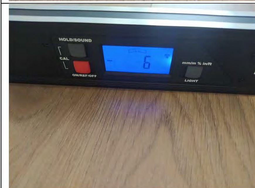
Фото №20. Измерение уровня напольного покрытия в кабинете.
