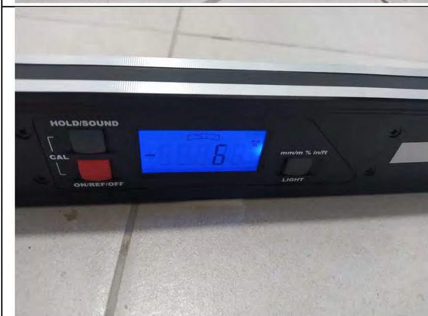
Фото №24. Измерение уровня напольного покрытия в санузле (керамическая плитка).
