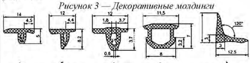
а — Т-образный пристенный профиль, вариант 1; б — Т-образный пристенный профиль, вариант 2; в — Т-образный пристенный профиль, вариант 3; г — соединительный профиль — заглушка; д — Л-образный пристенный профиль»
