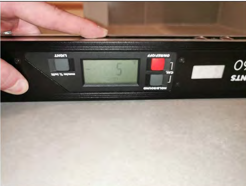
Фото №26. Измерение уровня пола в ванной комнате.
