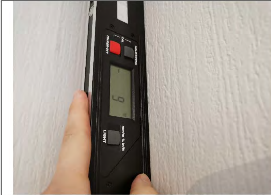
Фото №10. Измерение уровня стен в спальне.
