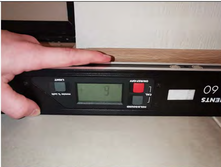
Фото №25. Измерение уровня пола в коридоре.
