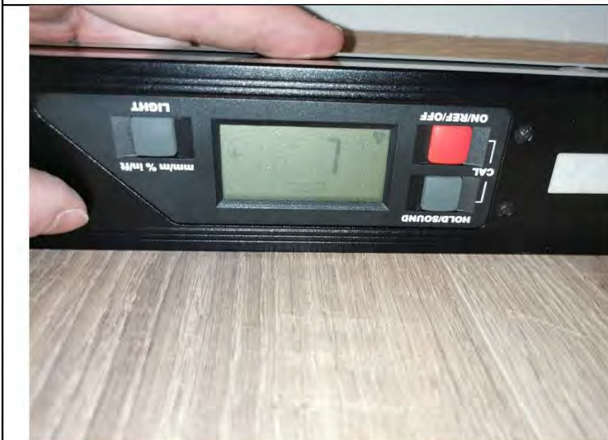
Фото №20. Измерение уровня пола на кухне.
