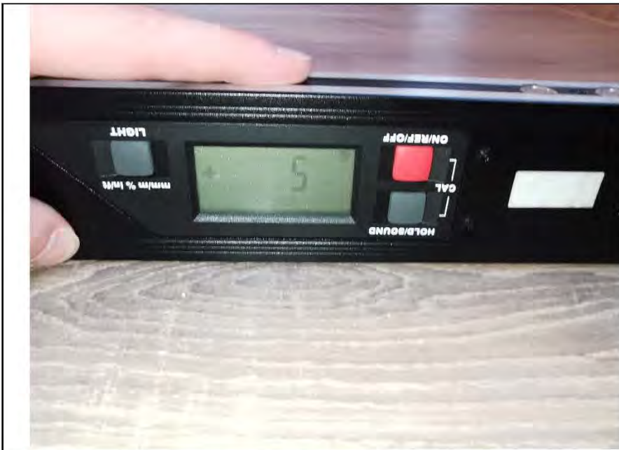
Фото №19. Измерение уровня пола в спальне.
