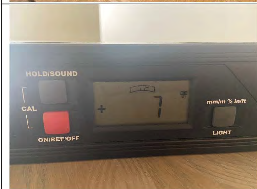
Фото №21. Отклонение поверхности напольного покрытия в спальне.
