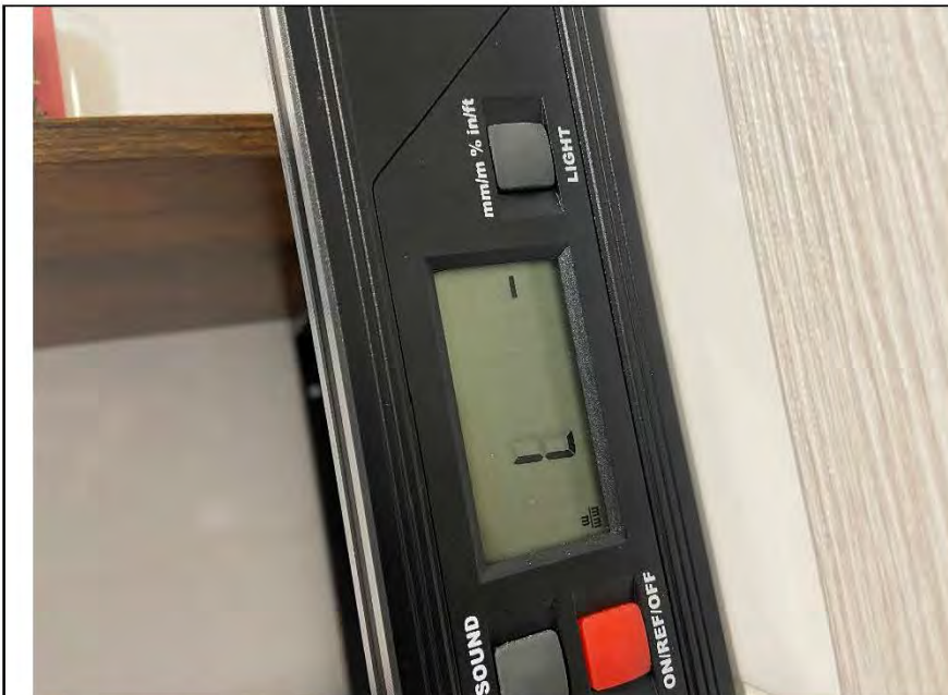
Фото №13. Измерение уровня стен в ванной комнате.
