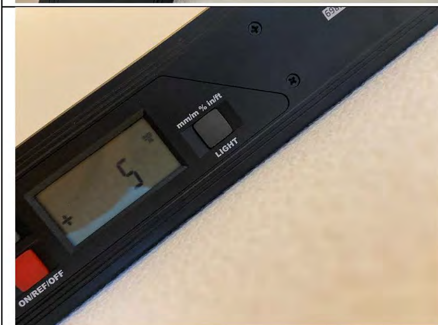
Фото №9. Измерение уровня стен в коридоре.
