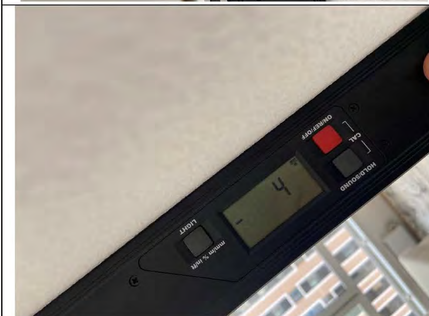
Фото №11. Измерение уровня стен в спальне.
