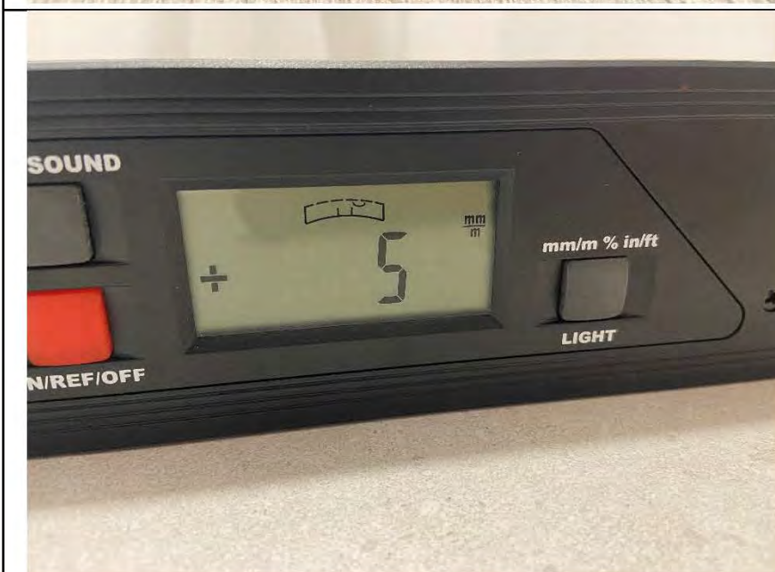
Фото №23. Отклонение напольного покрытия из керамической плитки в санузле.
