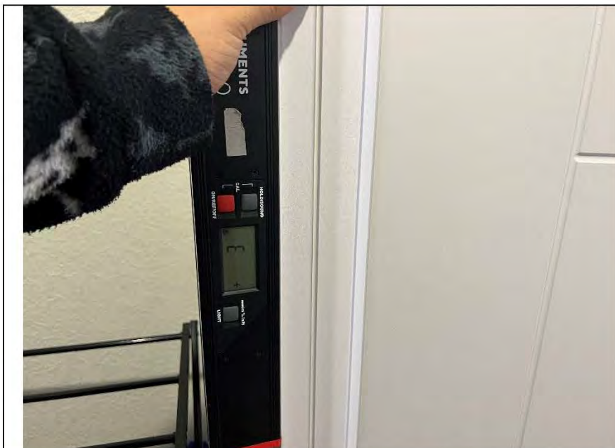
Фото №43. Отклонение коробки от плоскостности и прямолинейности в спальне составляет 3 мм.
