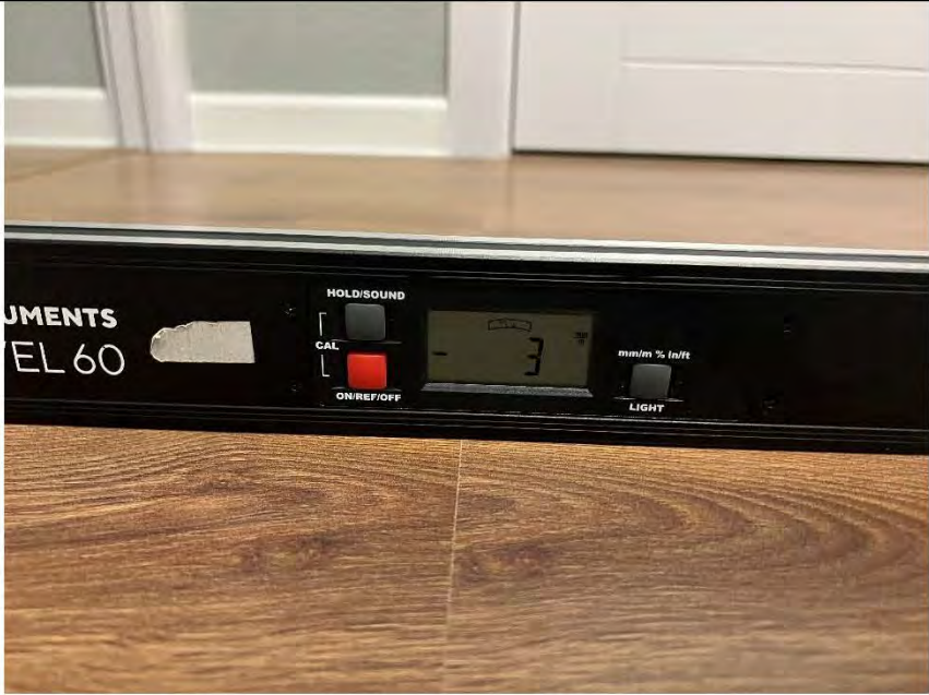
Фото №16. Измерение уровня напольного покрытия в коридоре.
