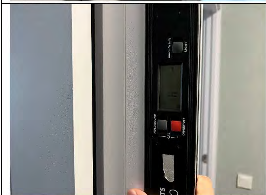
Фото №42. Отклонение коробки от плоскостности и прямолинейности в спальне составляет 4 мм.
