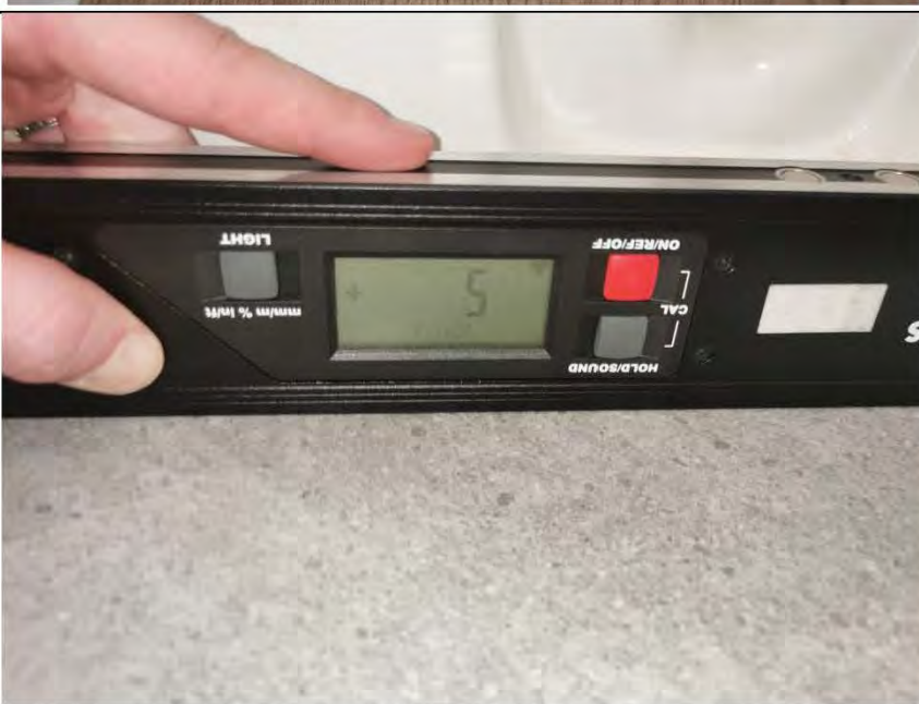
Фото №24. Измерение уровня пола в санузле.
