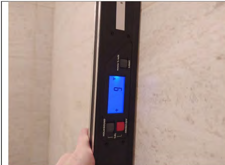
Фото №13. Измерение уровня стен в ванной комнате (керамическая плитка).
