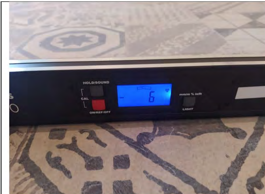
Фото №19. Измерение уровня напольного покрытия в кухне (керамическая плитка).
