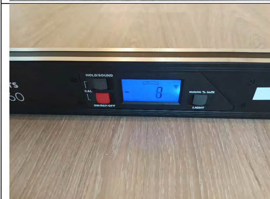
Фото №17. Измерение уровня напольного покрытия в кухне.
