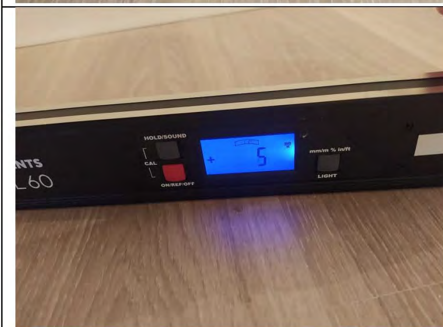
Фото №18. Измерение уровня напольного покрытия в прихожей.
