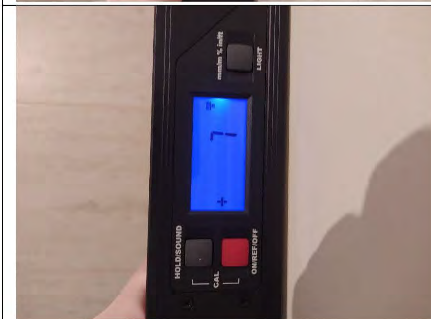
Фото №14. Измерение уровня стен в ванной комнате (штукатуренные и окрашенные стены).
