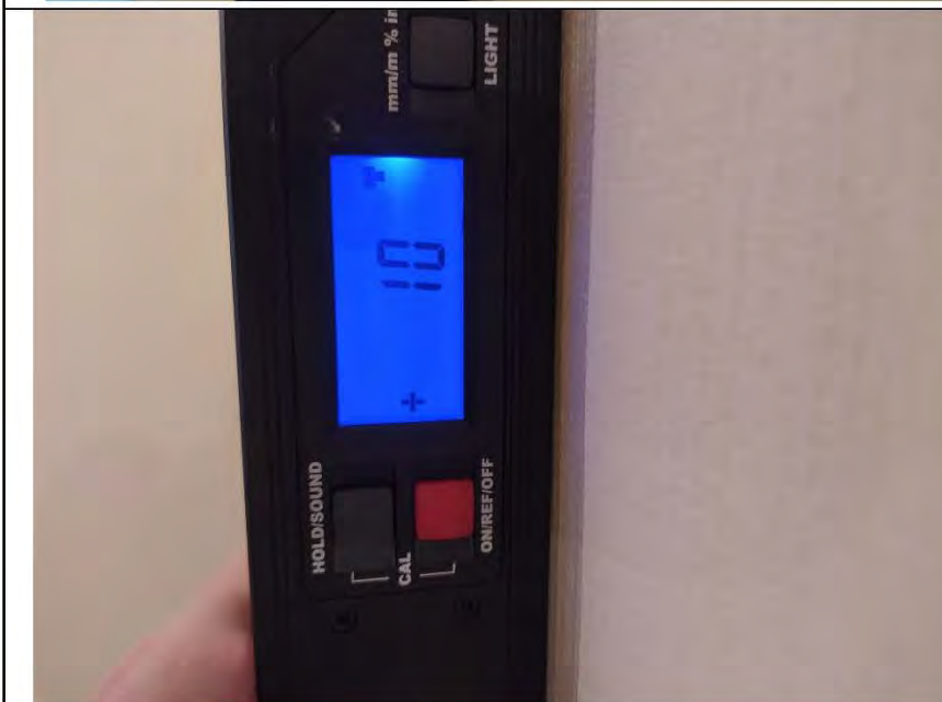
Фото №11. Измерение уровня стен в прихожей.
