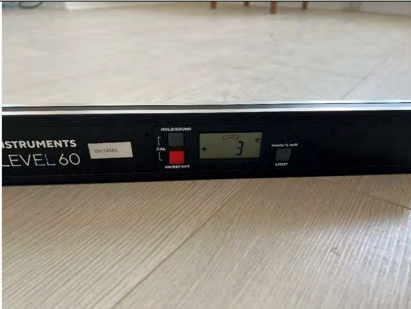
Фото №25. Измерение уровня напольного покрытия в кухне.
