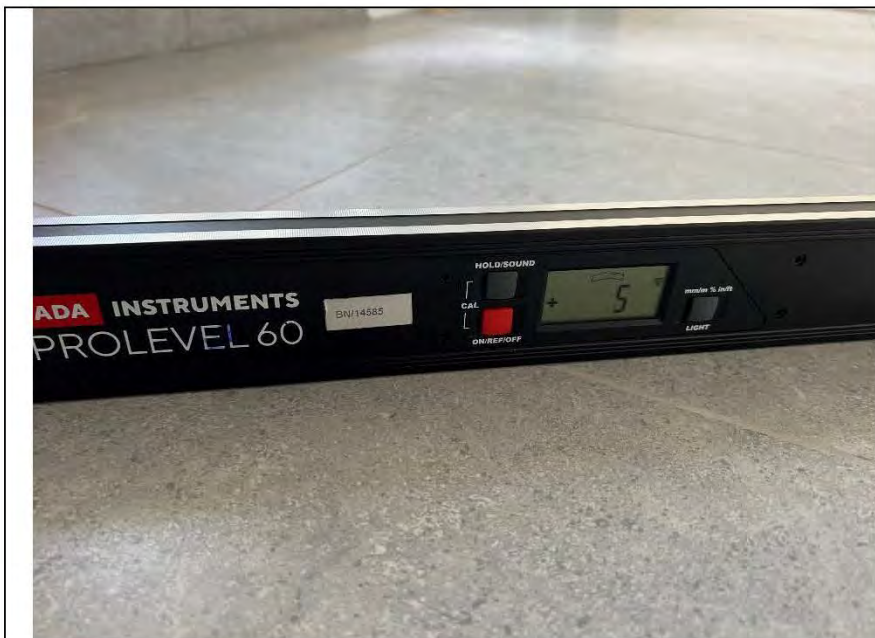
Фото №28. Измерение уровня напольного покрытия в кухне.
