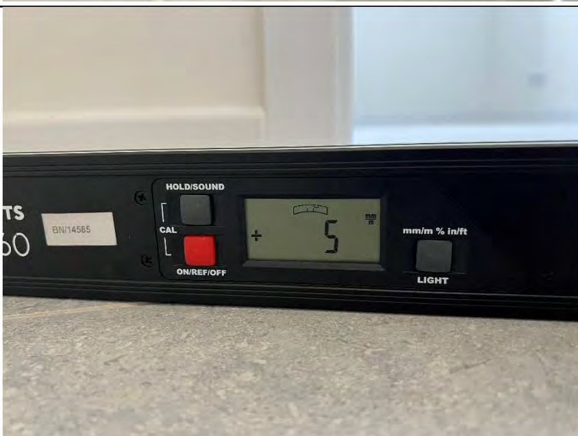
Фото №27. Измерение уровня напольного покрытия в прихожей.
