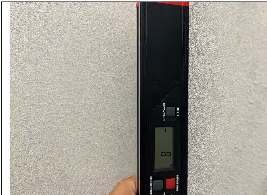
Фото №10. Измерение уровня стен в гардеробной.
