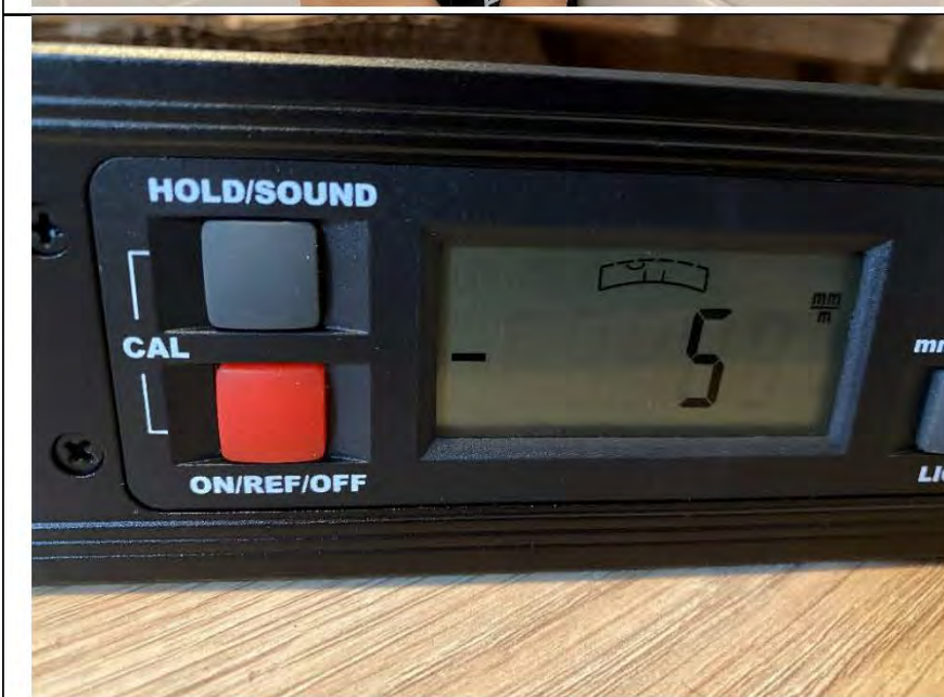
Фото №9. Измерение уровня напольного покрытия в спальне.
