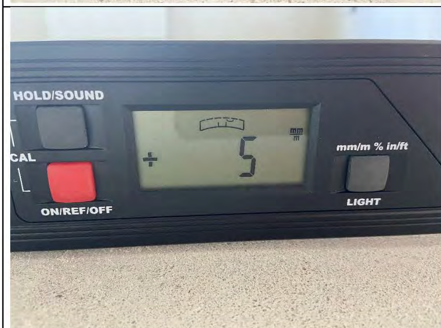
Фото №56. Отклонения напольного покрытия в коридоре в квартире.
