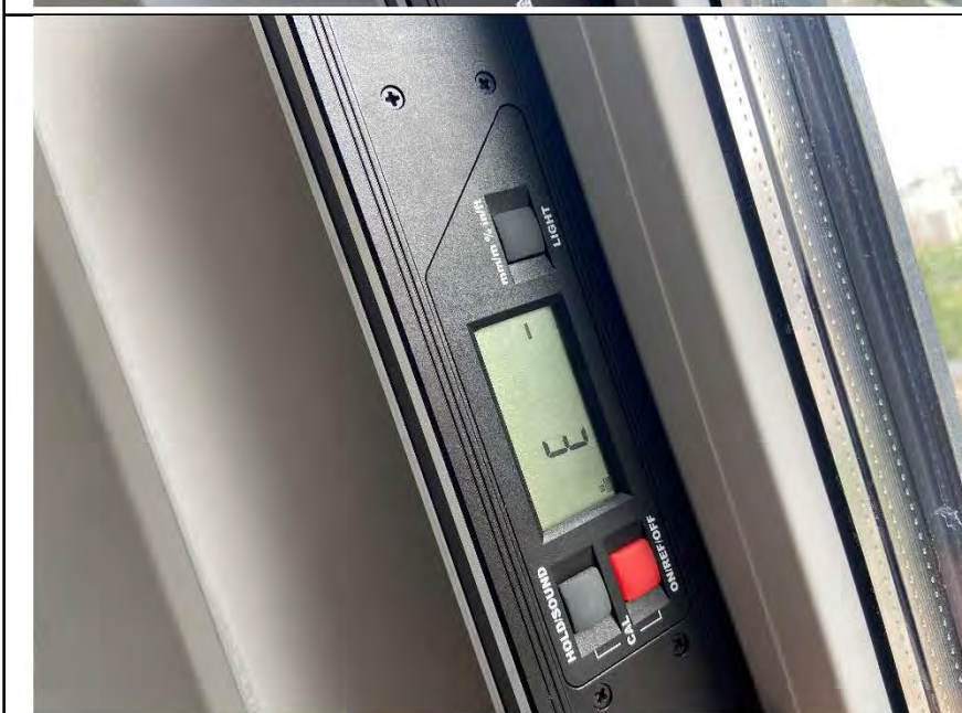
Фото №45. Отклонения оконного блока ПВХ по уровню вертикальности в кабинете в квартире.
