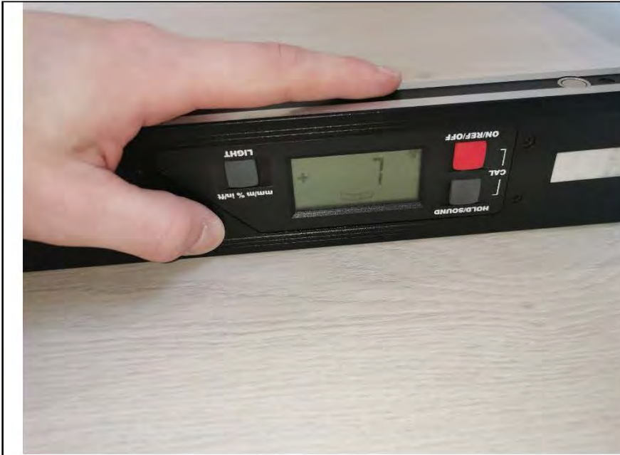
Фото №19. Измерение уровня пола в спальне.
