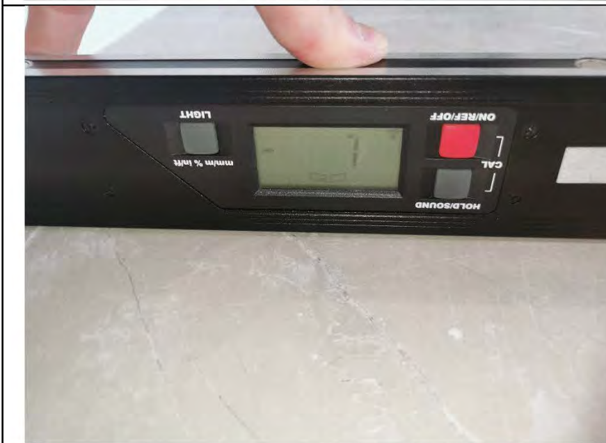
Фото №29. Измерение уровня пола в кухне.
