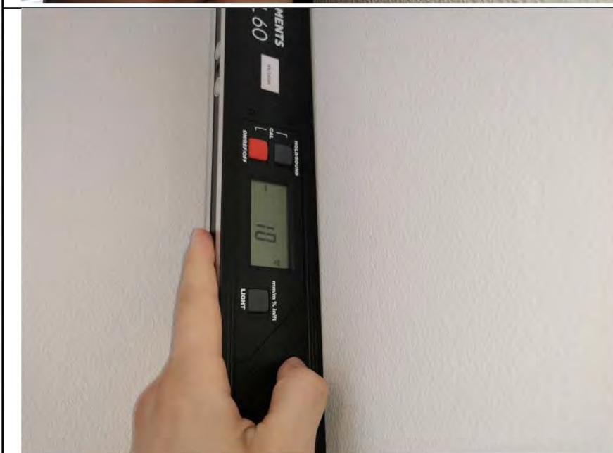
Фото №9. Измерение уровня стен в спальне.
