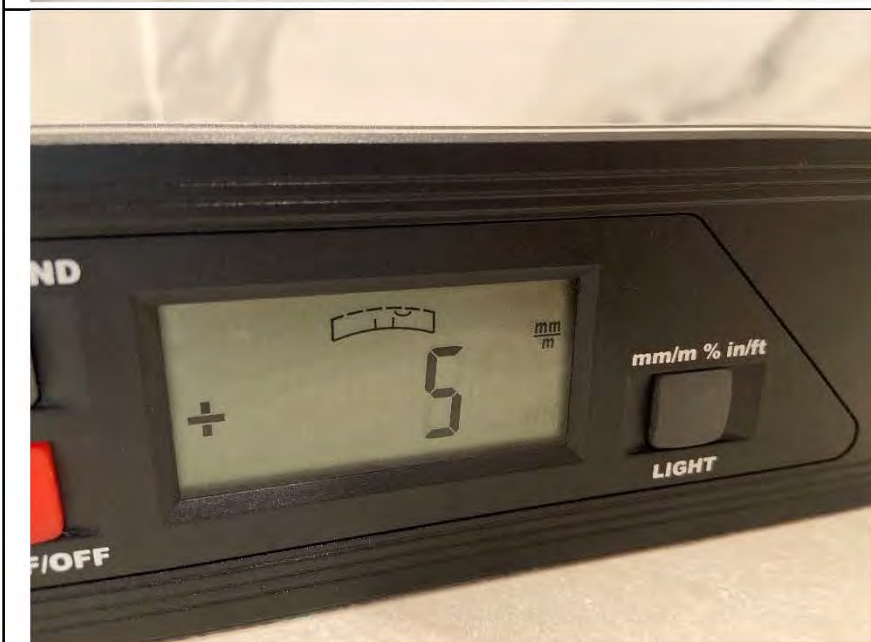
Фото №18. Отклонения поверхности напольного покрытия из керамической плитки в ванной комнате.
