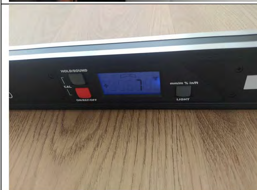
Фото №9. Измерение уровня напольного покрытия в спальне.
