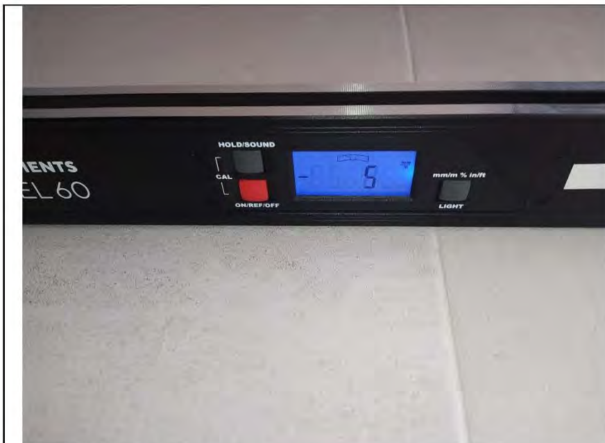
Фото №13. Измерение уровня напольного покрытия в ванной комнате (керамическая плитка).
