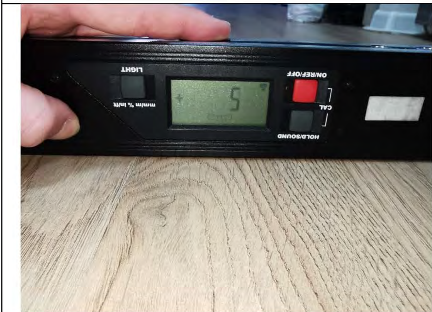
Фото №17. Измерение уровня пола в коридоре.
