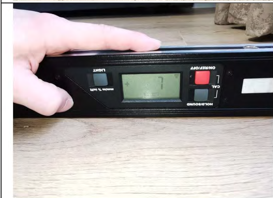
Фото №18. Измерение уровня пола в комнате.
