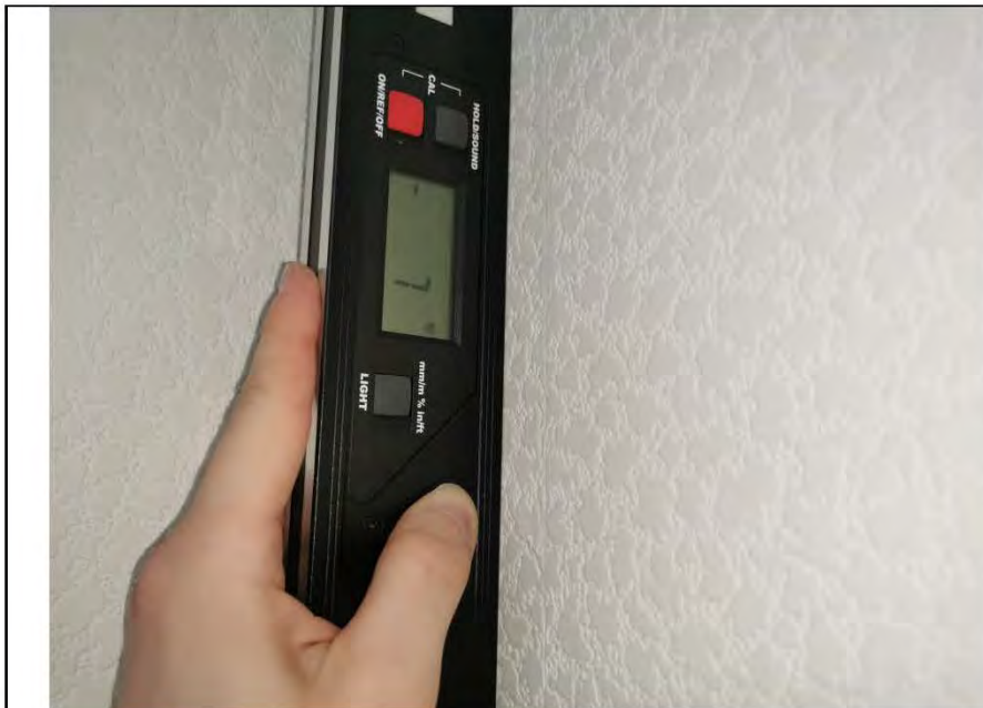
Фото №7. Измерение уровня стен в комнате.
