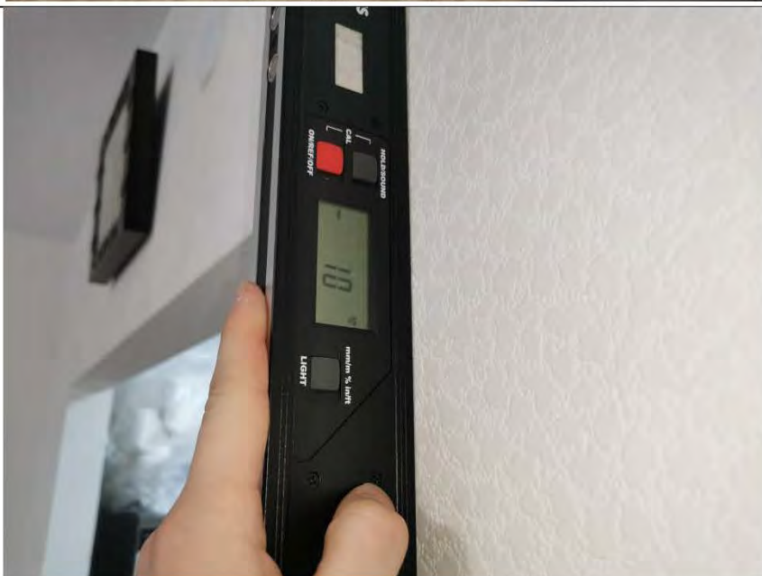
Фото №6. Измерение уровня стен в комнате.
