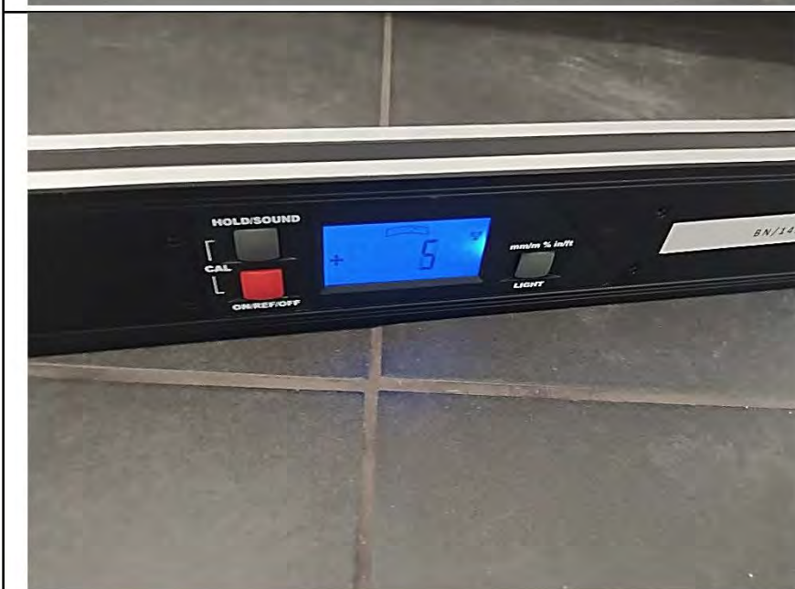
Фото №17. Измерения уровня напольного покрытия в ванной комнате (керамическая плитка).
