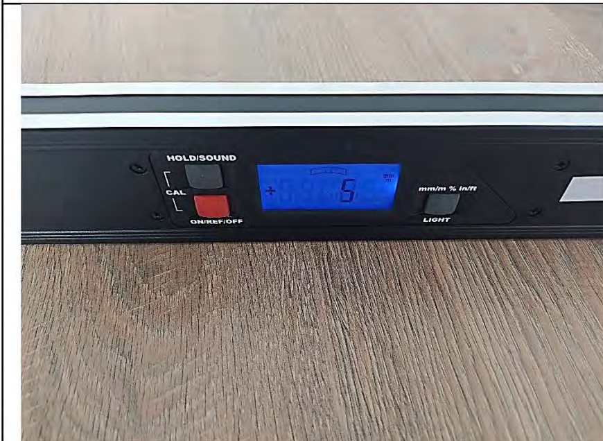
Фото №14. Измерения уровня напольного покрытия в спальне.
