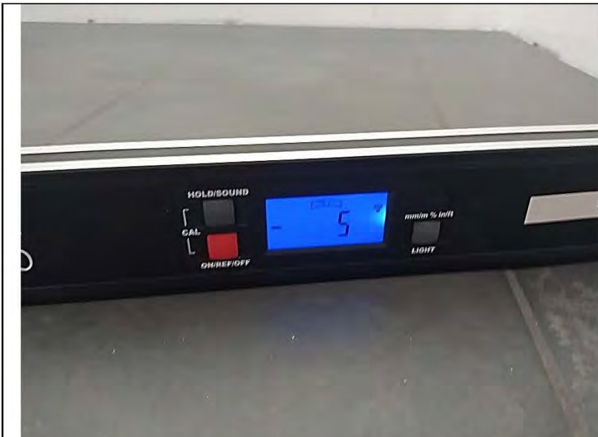
Фото №16. Измерения уровня напольного покрытия в санузле (керамическая плитка).
