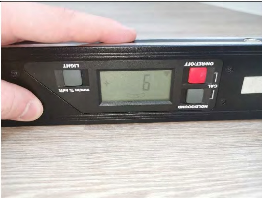
Фото №21. Измерение уровня пола в спальне.
