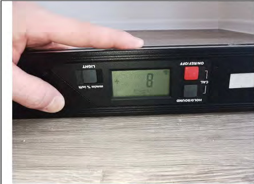
Фото №22. Измерение уровня пола в кухне.
