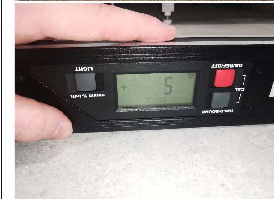
Фото №30. Измерение уровня пола в ванной комнате.
