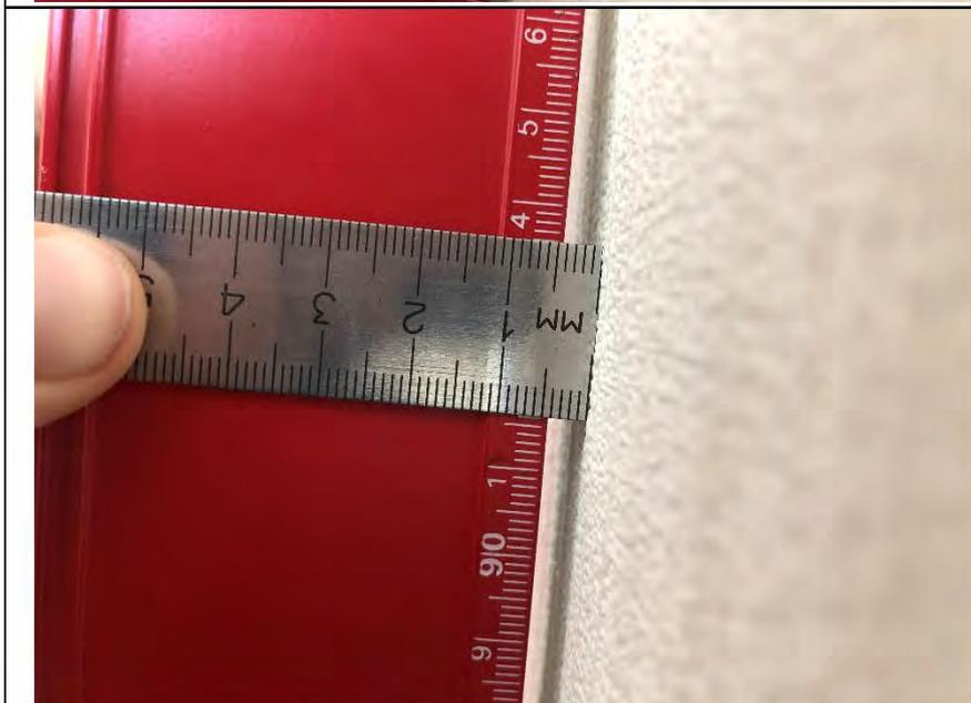
Фото №8. Измерение уровня стен спальни в квартире.
