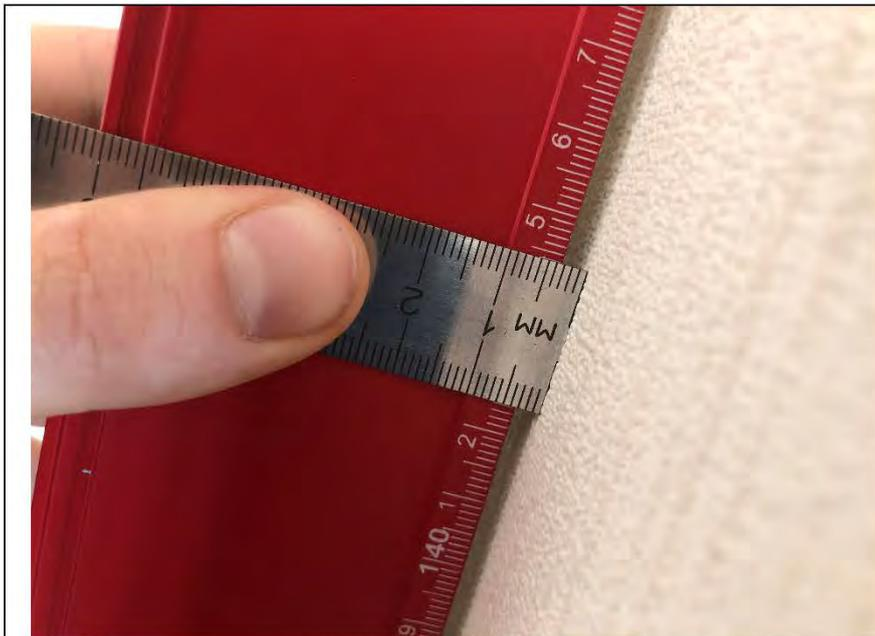
Фото №7. Измерение уровня стен коридора в квартире.
