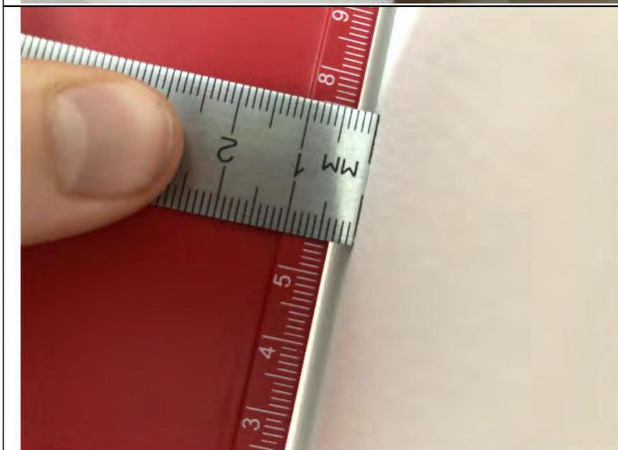
Фото №68. Измерение уровня стен ванной комнаты в квартире.
