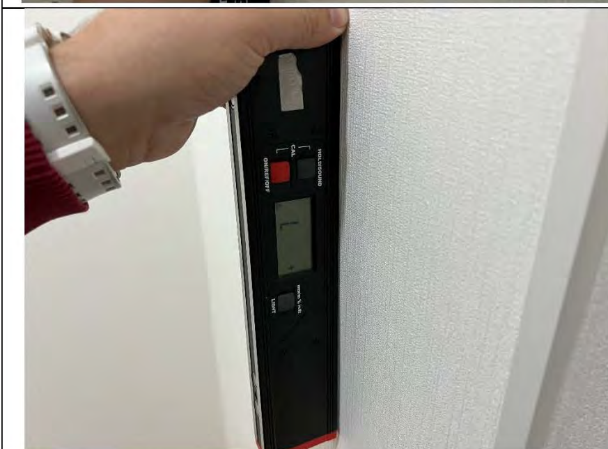
Фото №9. Измерение уровня стен в гардеробной.
