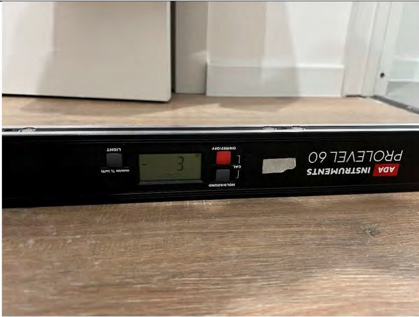
Фото №25. Измерение уровня напольного покрытия в прихожей.
