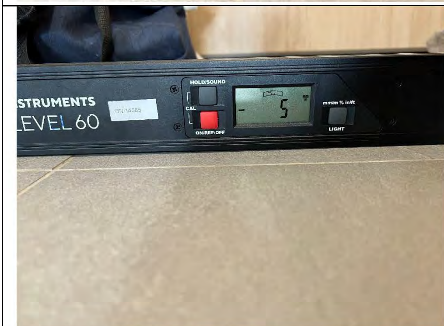
Фото №20. Измерение уровня напольного покрытия в прихожей.
