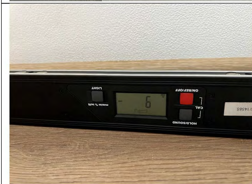
Фото №18. Измерение уровня напольного покрытия в спальне.
