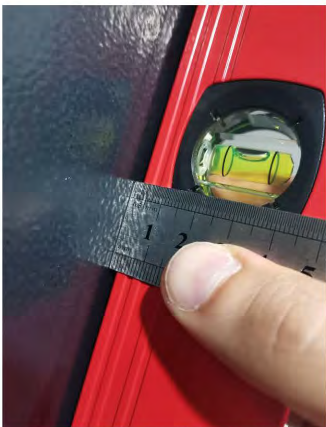
Фото 26-27. Коридор (3,2 кв.м.) 1.4 Дверной блок имеет отклонение от вертикали 2,5 мм
