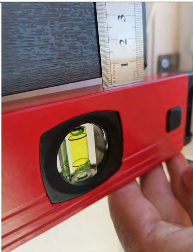
Фото 69-70. Кухня (20,1 кв.м.) 2.8 Отклонение кромки оконной створки от плоскости 5 мм, 2 мм
