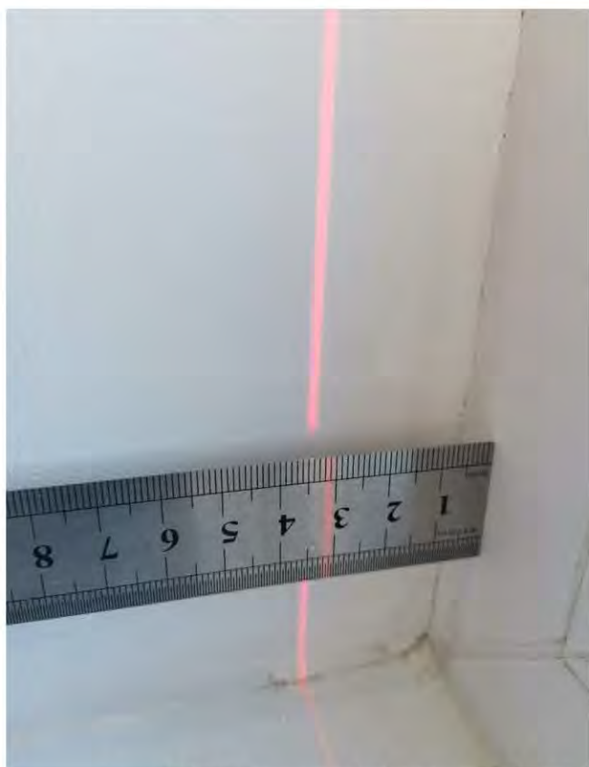
Фото 74-75. Кухня (20,1 кв.м.) 2.11 Отклонение оконного блока от вертикали 5 мм
