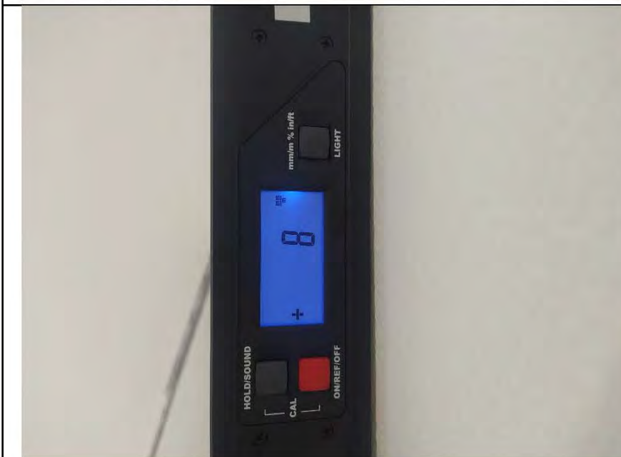
Фото №5. Измерение уровня стен в спальне.
