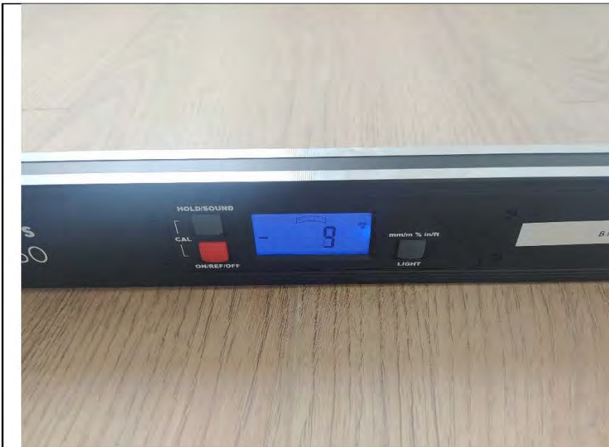
Фото №10. Измерение уровня напольного покрытия в кухне (ламинат).
