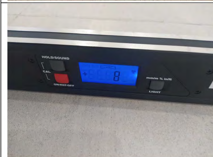
Фото №11. Измерение уровня напольного покрытия в кухне (керамическая плитка).
