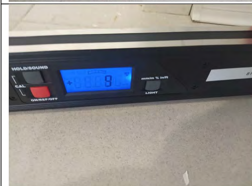
Фото №12. Измерение уровня напольного покрытия в прихожей (керамическая плитка).
