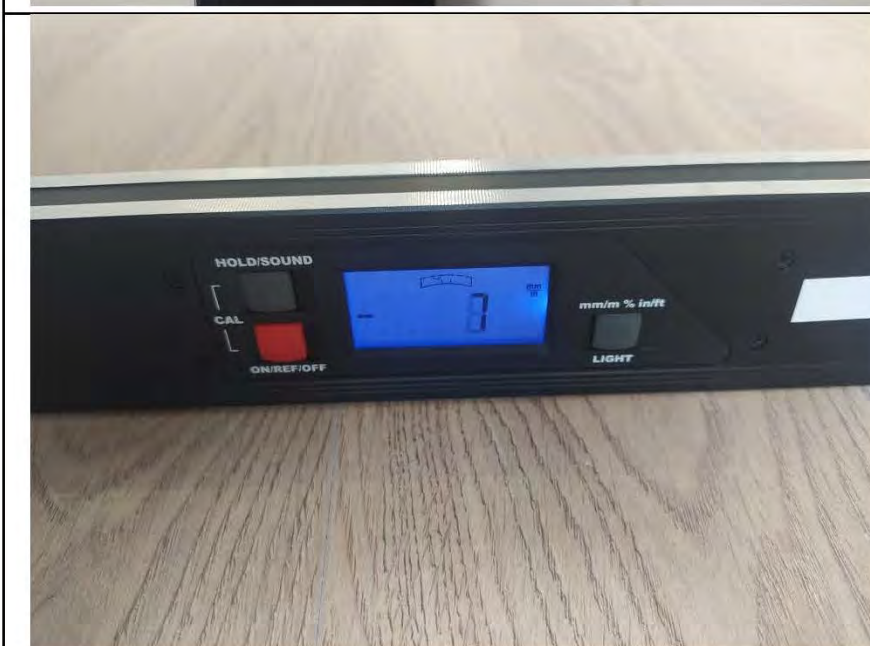
Фото №9. Измерение уровня напольного покрытия в спальне.
