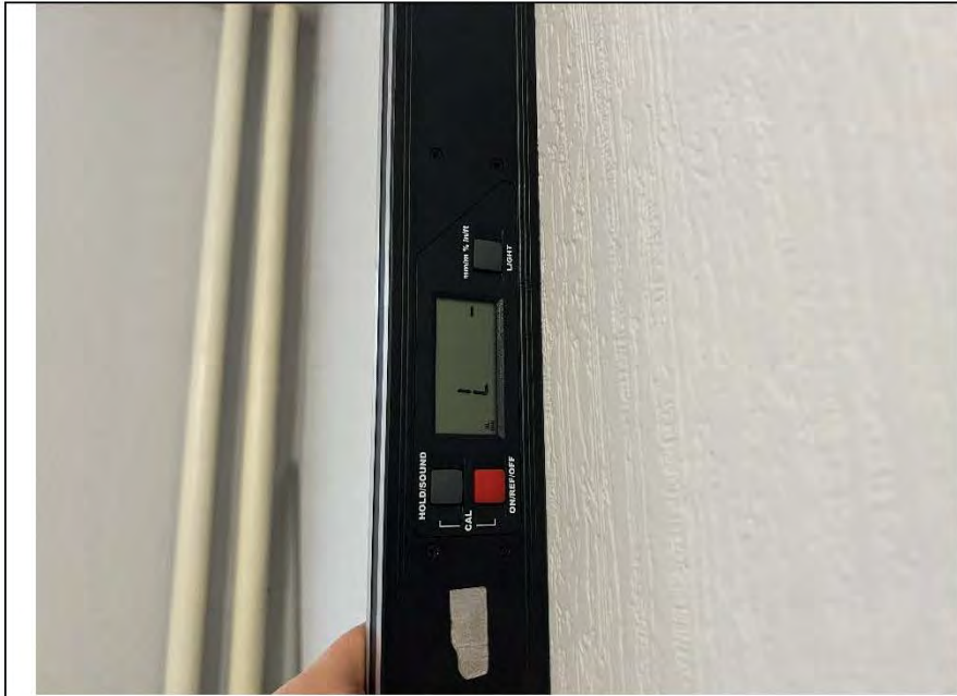
Фото №10. Измерение уровня стен в гостиной.
