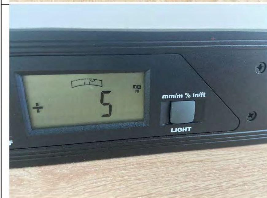
Фото №15. Отклонения поверхности напольного покрытия из ламината в кухне.
