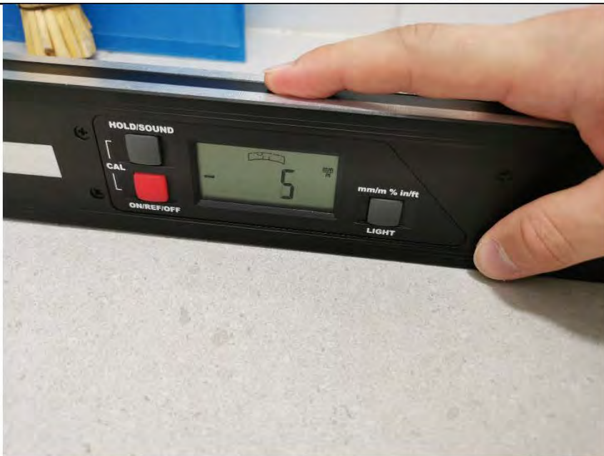
Фото №32. Измерение уровня напольного покрытия в санузле.
