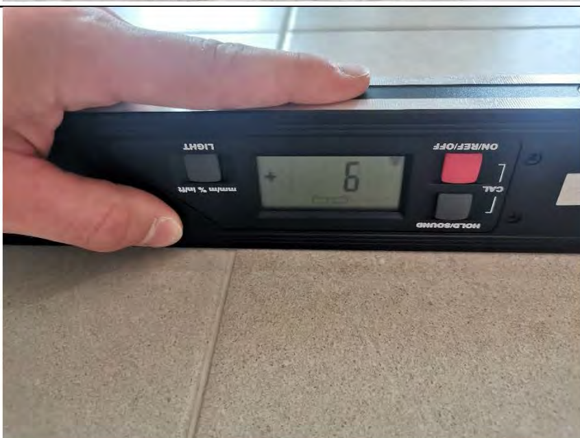
Фото №30. Измерение уровня напольного покрытия в коридоре.
