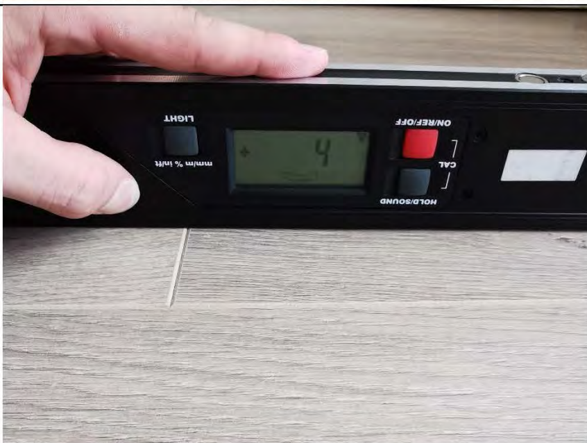
Фото №29. Измерение уровня напольного покрытия в кухне.
