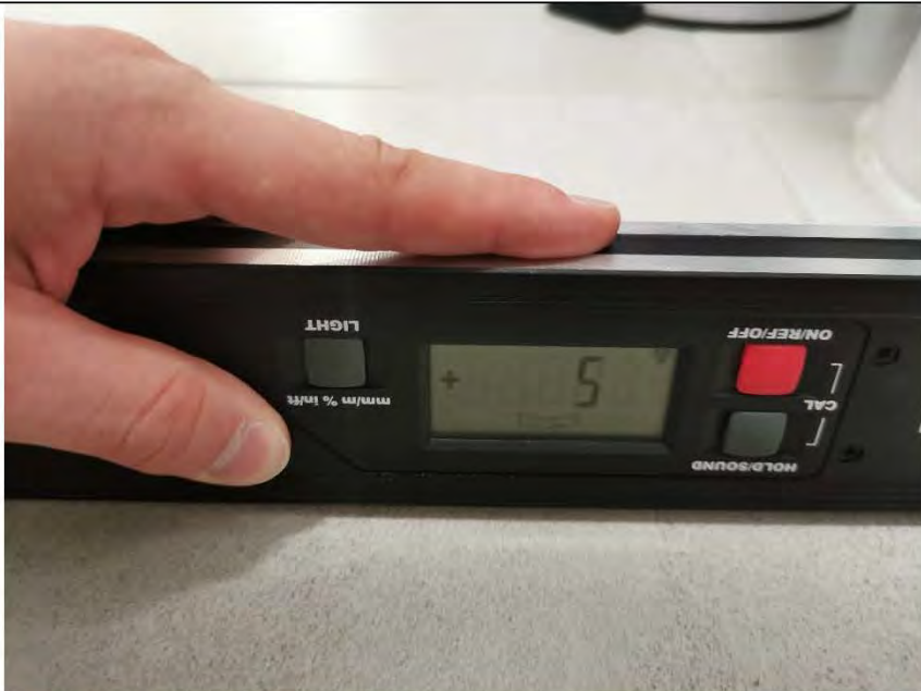
Фото №31. Измерение уровня напольного покрытия в ванной комнате.
