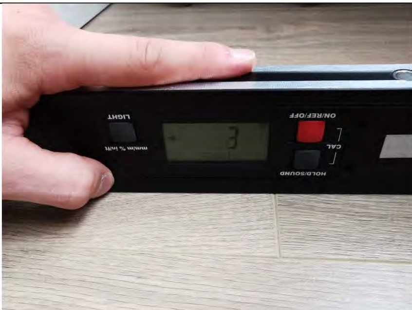
Фото №27. Измерение уровня напольного покрытия в спальне.
