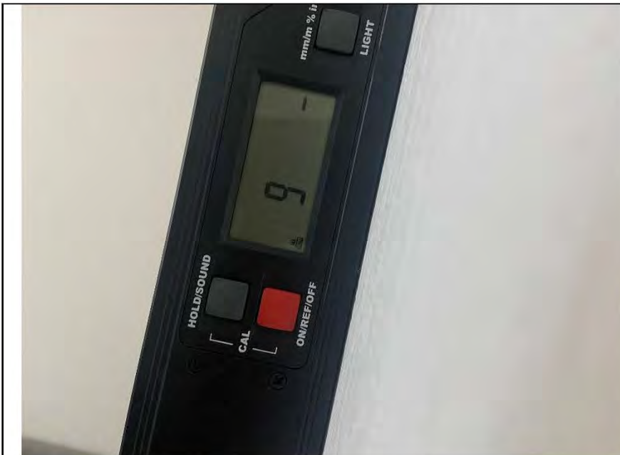
Фото №13. Отклонение поверхности стен от вертикали в детской.
