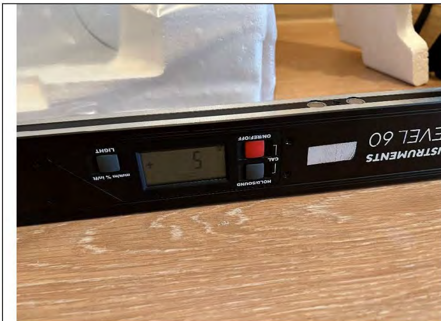
Фото №16. Измерение уровня напольного покрытия в коридоре.
