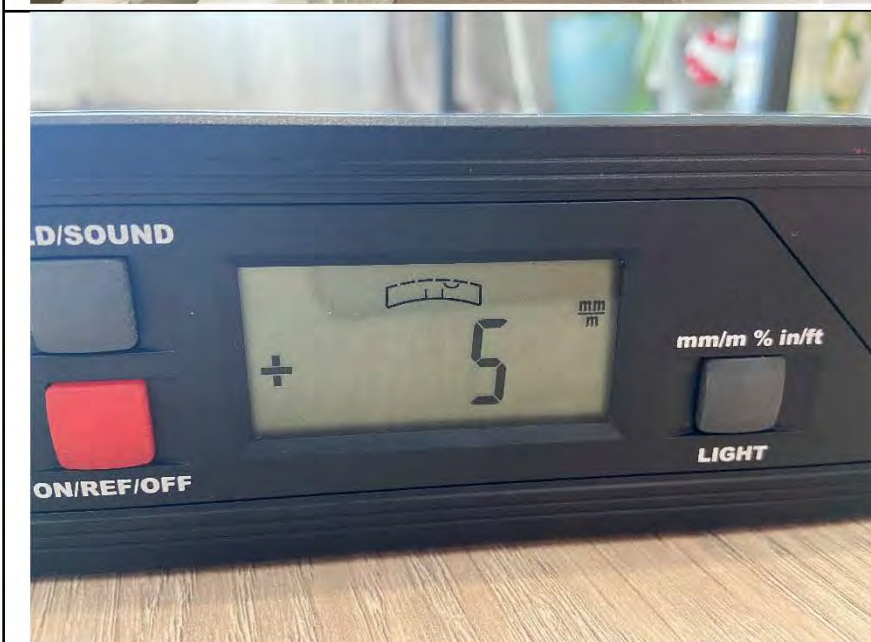
Фото №17. Отклонение напольного покрытия из ламината в кухне.
