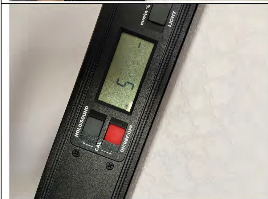
Фото №9. Отклонение поверхности стен от вертикали в детской.
