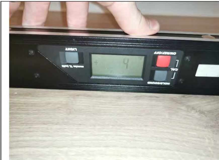
Фото №34. Измерение уровня пола в спальне.
