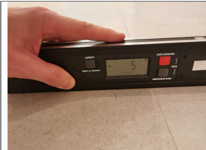
Фото №43. Измерение уровня пола в кухне.
