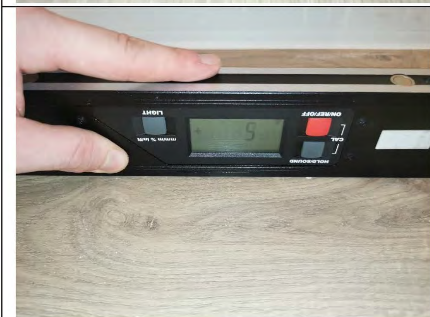
Фото №33. Измерение уровня пола в холле.
