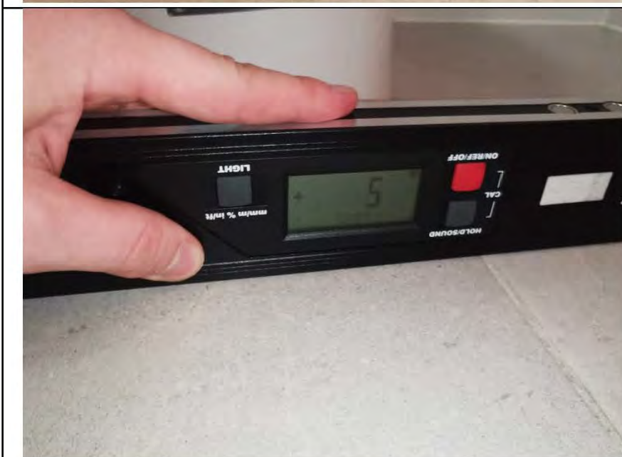
Фото №44. Измерение уровня пола в ванной комнате.
