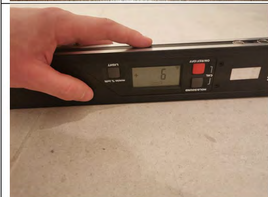
Фото №41. Измерение уровня пола в прихожей.
