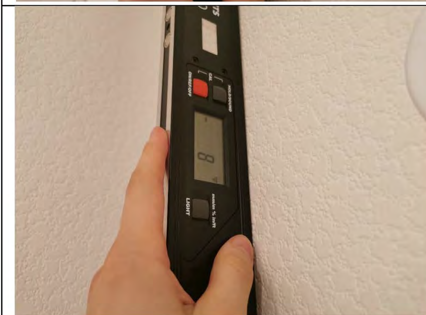
Фото №12. Измерение уровня стен в кухне.
