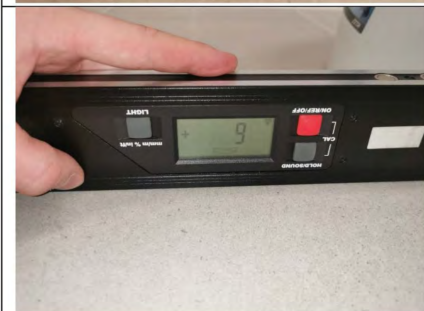
Фото №42. Измерение уровня пола в санузле.
