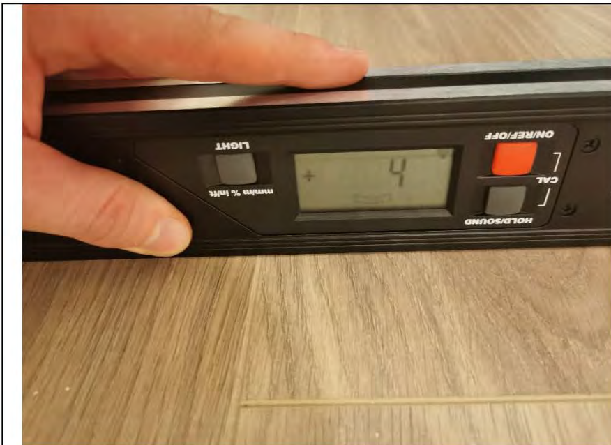
Фото №31. Измерение уровня пола в кухне.
