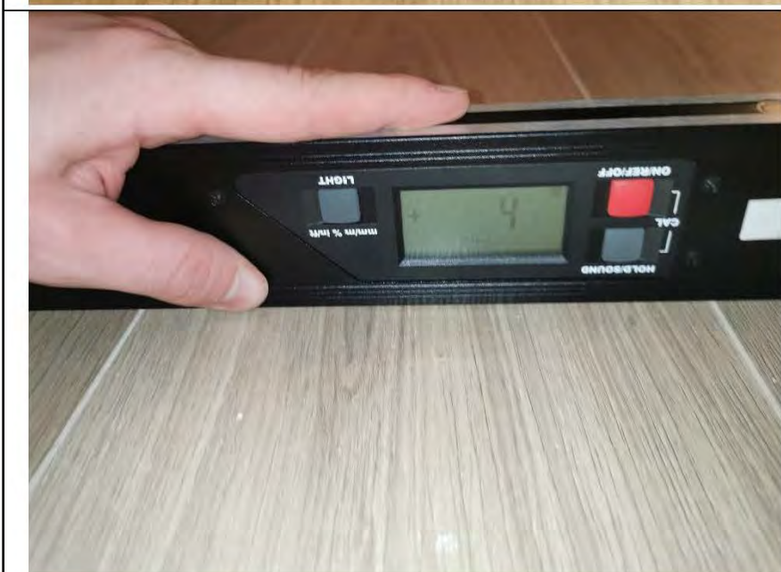
Фото №32. Измерение уровня пола в гостиной.
