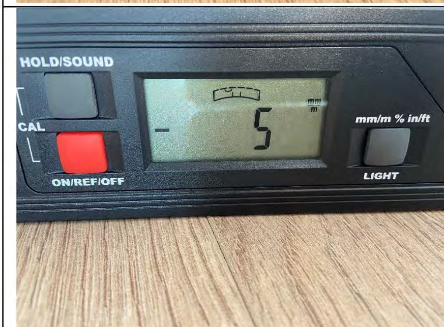
Фото №26. Отклонения поверхности напольного покрытия из ламината в кухне.
