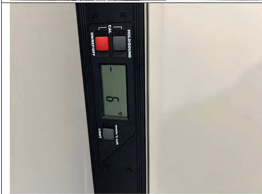
Фото №15. Измерение уровня стен в коридоре.
